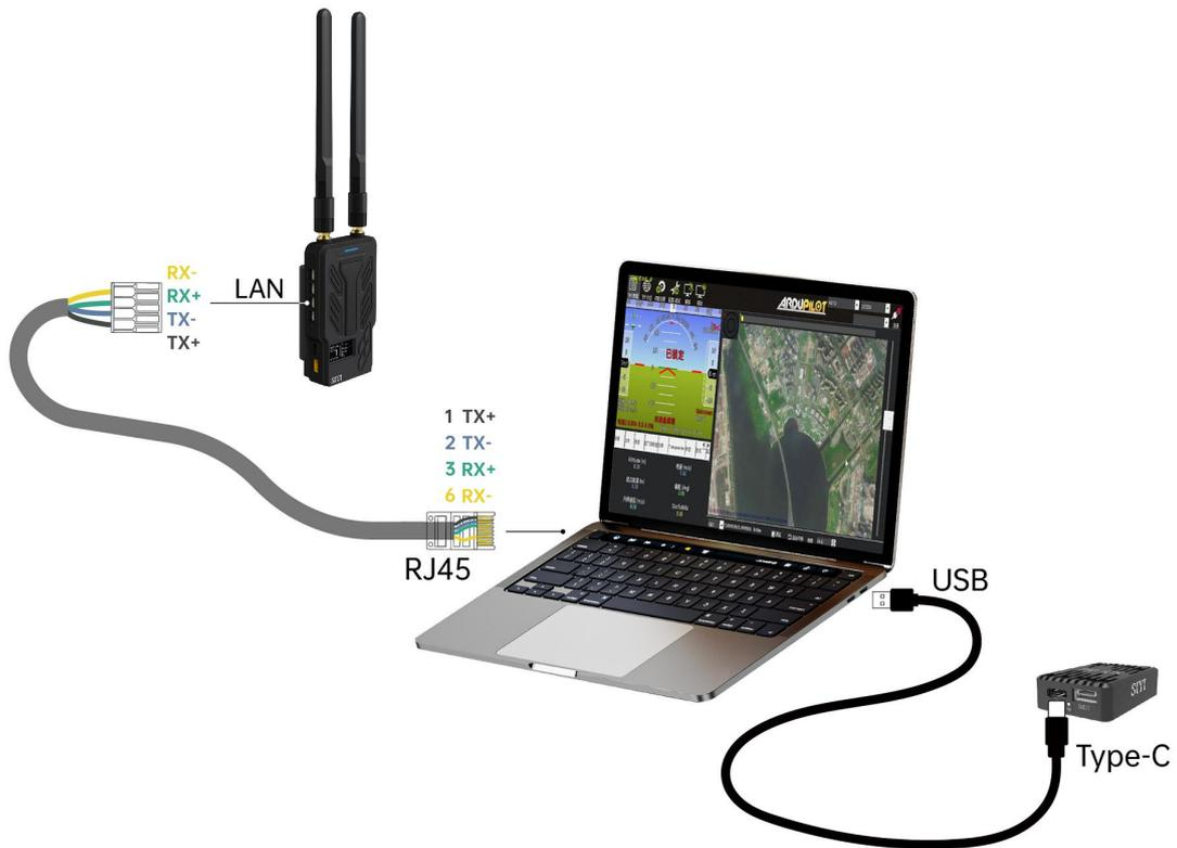
参考上图，架设 F9P RTK 基站。基站端与 PC 地面站通信，通过数传链路，将 RTK 基站的实时位置发送给飞控。
